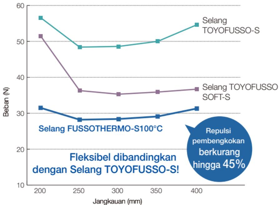
Metode pengujian: (Pengujian standar Toyox) Semua ukuran selang harus ø25. Kompres dan bengkokkan selang sampel seperti yang ditunjukkan oleh gambar di bawah, lalu periksa beban untuk setiap jangkauan yang diatur serta beban dan jangkauan pada beban maksimum.
