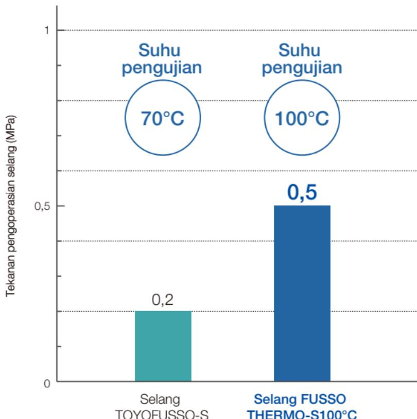
Metode pengujian: (Pengujian standar Toyox) Semua ukuran selang harus ø25. Tekanan pengoperasian selang adalah batas atas tekanan pengoperasian yang ada di tabel standar selang.
